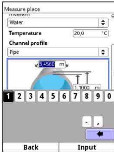
Figura 28-2 Especificando as dimensões do tubo
