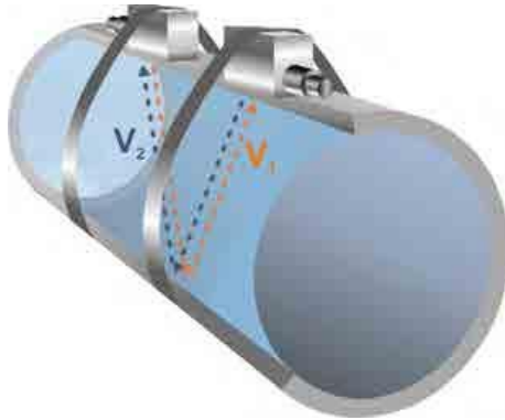
Figura 31-3 Medição de 1 caminho, disposição do caminho: "Diametral V"
